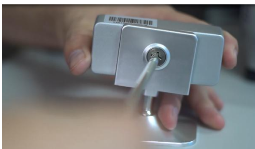
(1) Parafuse o sensor no suporte
